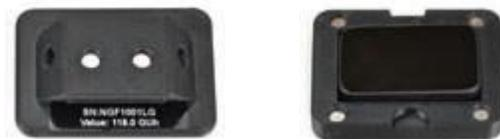
14. Im Falle von Verunreinigungen reinigen Sie die Kalibrierplatte mit dem im Lieferumfang enthaltenen fusselfreien Reinigungstuch. Verwenden Sie keine Lösungsmittel oder Reinigungsflüssigkeiten.
