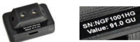
2. Befestigen Sie die Kalibrierplatte am Messkopf; für eine optimale Leistung legen Sie diese auf eine ebene Oberfläche.
