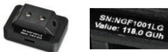
7. Befestigen Sie die Kalibrierplatte am Messkopf; für eine optimale Leistung legen Sie diese auf eine ebene Oberfläche.
