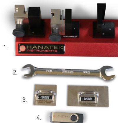
1. Halter für Klemmbacke 2. Maulschlüssel 3. Schablonen für die Probenvorbereitung 4. USB-Stick
