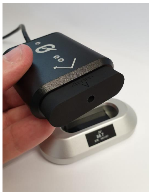
Im Druckverfahren hergestellter Adapter für gekrümmte Teile mit kleiner Punktgröße
