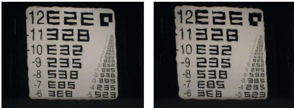
Zwei hochreflektierende Platten mit denselben Glanzwerten weisen nur geringe Abweichungen des DOI auf, haben aber ein unterschiedliches Erscheinungsbild.
