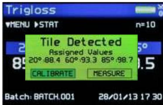
측정을 하기 전 교정 타일에 기기를 “Calibrate”하거나 교정을 수행하지 않고 측정 하는 두 가지의 옵션 사항이 있습니다. 키-패드에 왼쪽과 오른쪽 버튼(3)을 사용하고 버튼(4)을 눌러 요구하는 옵션을 선택 할 수 있습니다.
