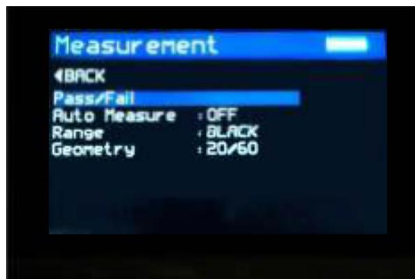
Measurement 화면은 사용자의 선호에 맞게 기기의 측정 parameters를 구성하는데 사용됩니다. Up 과 Down 버튼은 옵션들을 탐색하고, Enter 버튼은 옵션을 선택 합니다.
