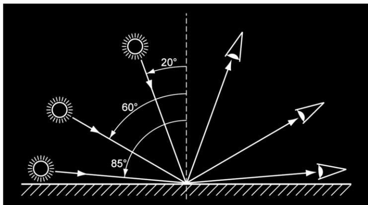
광택에 일반적으로 사용되는 측정 각도는  $20^\circ$ ,  $60^\circ$  와  $85^\circ$ 입니다.
