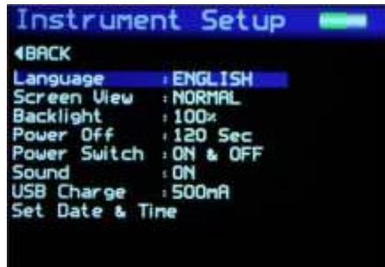
Instrument Setup 화면은 사용자의 선호에 맞게 기기의 기본적인 작동 환경을 구성하는데 사용합니다. Up 과 Down버튼을 눌러 옵션들을 탐색 하고, Enter 버튼을 눌러 옵션을 선택 합니다.
