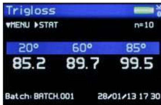
pass fail 기능의 활성화로, Novo-Gloss는 각 측정 각도와 사용자 설정 허용 오차 값을 비교합니다. 광택의 수치가 설정값 이내이면, 그 각도는 녹색으로 표시 됩니다. 만약 수치가 허용 값 아래로 떨어 지면 각도는 빨간색으로 표시 되어 집니다.
