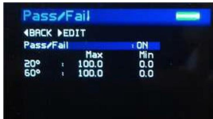
pass fail 설정 화면은 화면에 pass/fail 표시를 활성화/ 비활성화 시키는데 사용하고 측정 기준을 설정 합니다.
