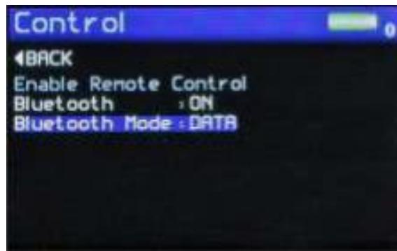
Control 화면은 사용자의 선호에 맞게 기기의 Bluetooth parameter를 구성하는데 사용합니다. Up 과 Down 버튼으로 옵션들을 탐색하고 Enter 버튼을 눌러 옵션을 선택 합니다.
