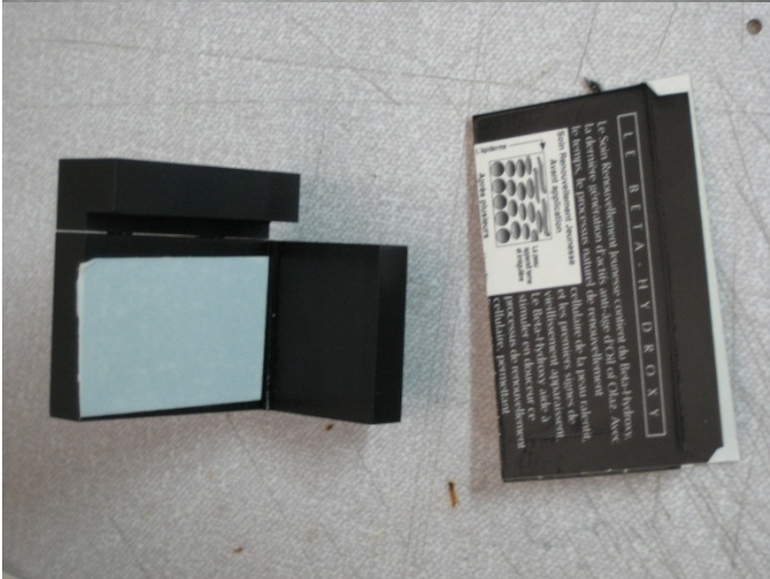
Fixieren Sie doppelseitiges Klebeband auf der Klemmbacke für die Rill/ Falzöffnung
