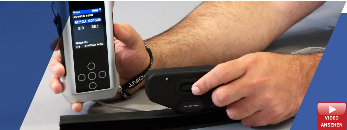
Das Novo-Gloss Flex 60 Glanzmessgerät wurde speziell für die Glanzmessung von Oberflächen entwickelt, an denen herkömmliche Glanzmessgeräte scheitern. Es kombiniert die Funktionalität und Auswertung eines hochentwickelten Glanzmessgerätes mit einem extrem handlichen und modifizierbaren Messkopf.
