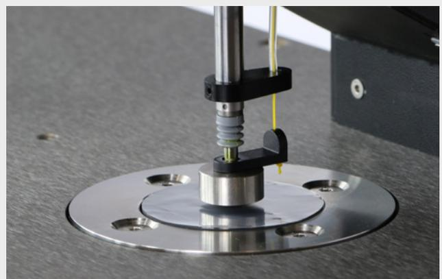
Ebenheit des Messkopfs/Messtisches < 0,2 µm;
