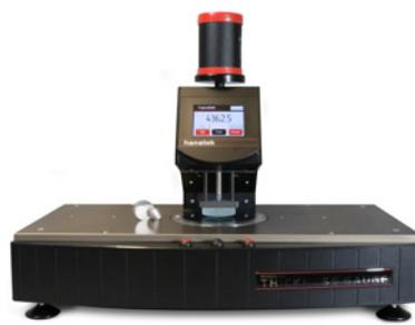
Um den Druck gemäß den Anforderungen der Standards zu variieren, werden Gewichte hinzugefügt.
