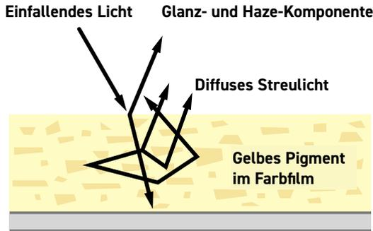
Das Novo-Gloss™ 20/60/85 mit Haze kompensiert die Reflexion von hochreflektierenden Pigmenten, metallischen Beschichtungen und Spezialeffektpigmenten und ermöglicht so die Haze-Messung auf jeder lackierten Oberfläche.
