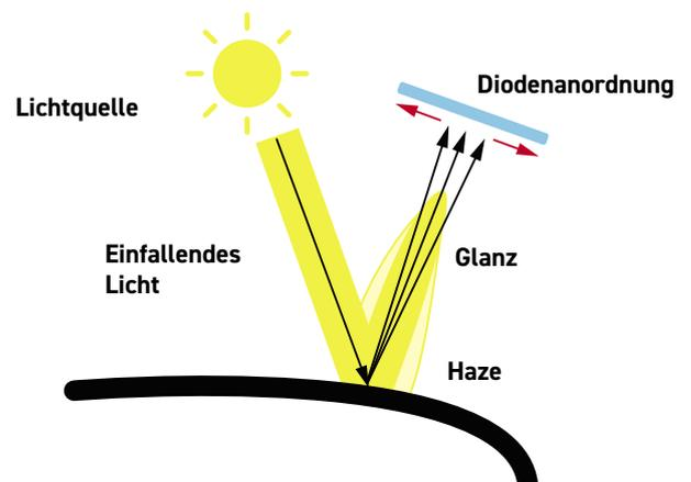
Das Novo-Gloss™ 20/60/85 mit Haze passt die Messung bei unebenen Oberflächen automatisch an, indem es den Spitzenwert des reflektierten Lichts erkennt und die Position virtuell entsprechend einstellt.
