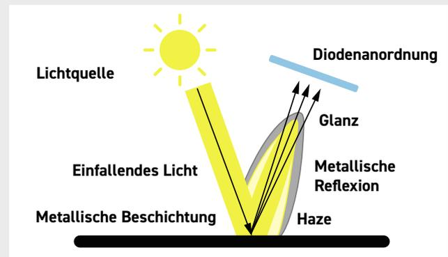
Das Novo-Gloss™ 20/60/85 mit Haze erfasst Kompensationsinformationen aus Regionen, die an den Haze-Messwinkel angrenzen. Dadurch kann es auch auf metallischen Beschichtungen angewendet werden, die Licht gerichtet reflektieren.
