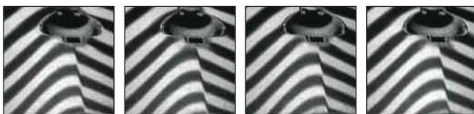
Al utilizar el perfil de patrón sinusoidal ortogonal sobre la superficie, se obtienen los datos de pendiente multidimensional y curvatura.
