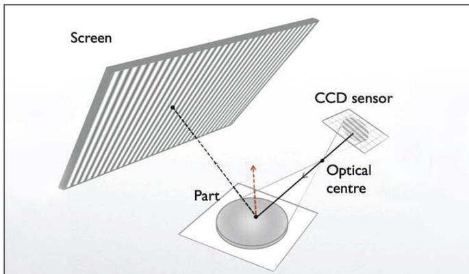
Al desplazarse o "paso a paso" la fase de forma de onda permite una medición precisa de cada punto de la superficie a través del punto correspondiente al píxel de la cámara. Utilizando la relación geométrica entre la pantalla, la superficie y la cámara, los rayos de luz reflejados se modelan espacialmente para calcular la dirección del estándar en cada punto de la superficie, permitiendo así, obtener el perfil en ese punto.
