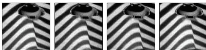
Eine orthogonale Anwendung des Sinusmusterprofils auf die Oberfläche ergibt mehrdimensionale Krümmungs- und Neigungsdaten.
