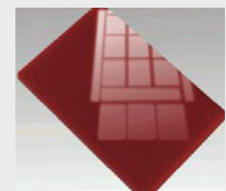
Probe 2 Starker Haze, verminderter Reflexionsgrad
