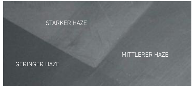
Haze: Häufig als milchiger Schleier auf Hochglanzoberflächen zu erkennen
