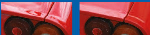
El brillo también puede ser una medida de la calidad de la superficie; por ejemplo, una disminución del brillo de una superficie revestida puede indicar problemas con su curado, lo que provocaría otros fallos como una mala adherencia o la falta de protección de la superficie revestida.
