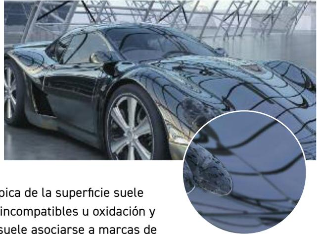
En la industria de los revestimientos, esta textura microscópica de la superficie suele deberse a materias primas mal dispersas, materias primas incompatibles u oxidación y meteorización. En las superficies metálicas pulidas, el velo suele asociarse a marcas de pulido o residuos químicos.
