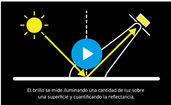
El ángulo de la luz y el método por el que se mide la reflectancia vienen determinados por el material de la superficie y por el aspecto de la superficie que debe medirse.
