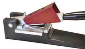
Universal-Probenschneider Mit dem Universal- Probenschneider von Hanatek ist die Probenvorbereitung einfach.
