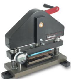
Kartonfalzgerät Herstellung von Rill-/Falzproben in Produktionsqualität, ohne wertvolle Maschinenzeit zu belegen.
