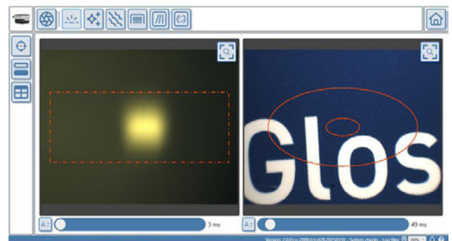
Các phép đo tương tác Aesthetix® hiển thị chế độ xem trực tiếp từ cả hai camera, đảm bảo vị trí và căn chỉnh hoàn hảo trên tất cả các bề mặt.
