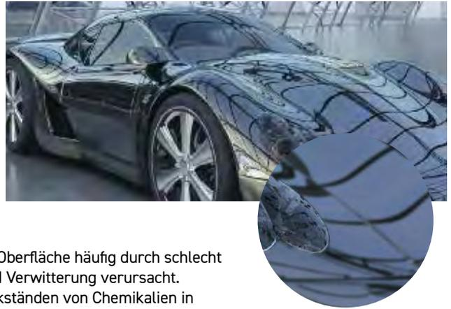
In der Beschichtungsindustrie werden diese Mikrostrukturen auf der Oberfläche häufig durch schlecht verteilte oder inkompatible Rohmaterialien sowie durch Oxidation und Verwitterung verursacht. Bei polierten Metallen steht Haze häufig mit Schleifkratzern oder Rückständen von Chemikalien in Zusammenhang.
